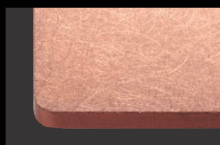
M-19: 銅パイブレーション
