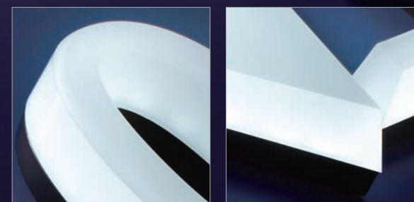
[Photo-N_04b] 発光色：白（6500K） 拡散樹脂：t20 × 5R + 8° 拡散樹脂：t10 側面塗装色：黒
