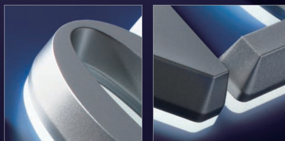
[Photo-N_07] 発光色：白（6500K） 拡散樹脂：t20×15° + ストレートカット 乳半アクリルt5 正面・側面塗装色：シルバーメタリック（荒目）
